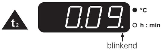
Beachten Sie, dass bei Kontrolle von  $t_1$  bzw.  $t_2$  nur die verbleibende **Restzeit** im Segment gezeigt wird.
