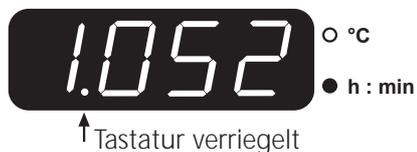
Die PYROTEC D1 kann über die Tastaturverriegelung gegen unbefugten Eingriff gesichert werden. Drücken der Taste (4) verriegelt die Tastatur. Der Dezimalpunkt links in der Anzeige (1) bedeutet „Tastatur verriegelt“. Nach Verriegelung der Tastatur können nur noch Werte abgefragt werden, nicht aber z.B. der Brennvorgang unterbrochen werden.
