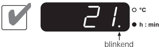
Zum Start des Brandes drücken Sie die Taste (12). Die Anzeige (1) zeigt während des Brennvorganges die aktuelle Ofentemperatur dar. Alle 20 Sekunden wird die Endtemperatur blinkend eingeblendet.
