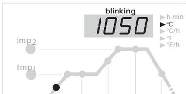
Normalerweise erscheint auf der Anzeige (14) während des Brandes die aktuelle Solltemperatur. Beim Aufheizen „zählt“ diese Temperatur entsprechend der Vorgabe hoch. Alle 15 Sekunden blinkt zweimal kurz die Maximaltemperatur der Brennkurve auf. Somit können Sie ohne Tastendruck kontrollieren, daß Sie diesen wichtigen Wert richtig eingegeben haben.
